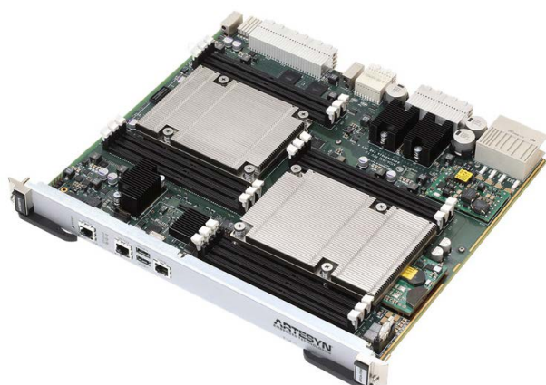
图 3. ATCA-7540 服务器刀片专为计算密集型国防通信设计。 (资料来源: Artesyn Embedded Technologies)
